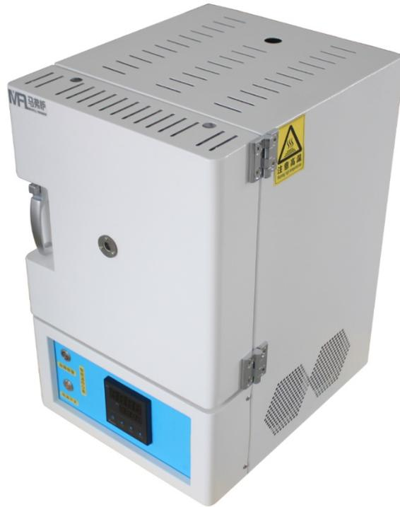
MFLXD-12 系列是一款最高 1200℃ 的高温箱式炉。该系列使用操作简便，性能稳定，安全性高。可用于高校、科研院所、工矿企业 做高温烧结、金属退火、质量检测；粉末冶金行业及义齿加工行业的烘烤、氧化锆盘预烧结等。根据加热区大小，进行小试，中试，批量生产
