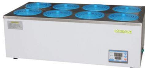
键设定方式，分别是设置键、加键、减键、手动加热后停键、自检键。并带有过热保护，超温报警、防干烧设定加热、电气元器件自检、漏电保护等功能。过温断开功能：在水蒸干或者当 2 个控制系统都失灵的情况下保护使用。自带校准功能，单点校准仪器的工作温度。
