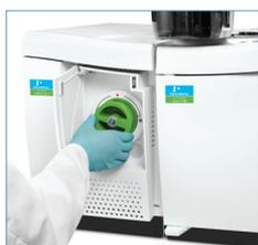
仅需旋转并轻拉, 即可对 Clarus SQ 8 GC/MS 上的免工具 SMARTsource 离子源进行操作。
