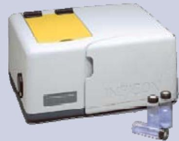
HAPSITE 源头取样系统 — 用于高精度现场分析水、土壤，和固体中的 VOCs，检测上限进入 PPT 量级。
