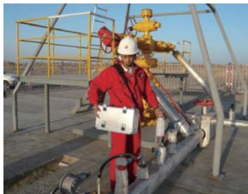
天然气汞含量现场监测
