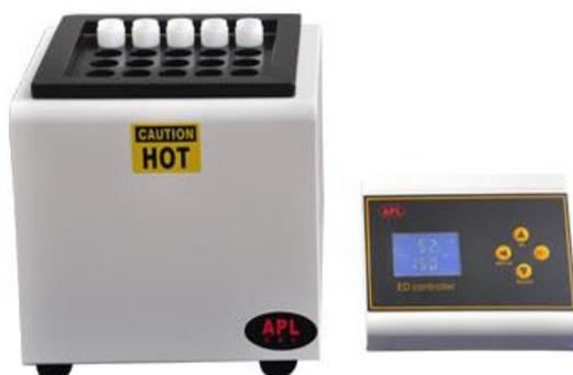
1、**商品简介：**采用国际先进技术，具有消解快速、高效、节能、方便等优点可用于微波消解的预处理和赶酸处理，是原子吸收、原子荧光、ICP-AES 等分析仪器的理想配套产品。
