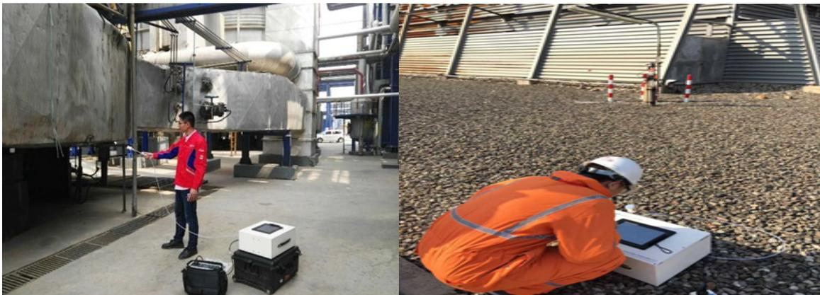
作为常规、有效的污染排放监管工具，便携式傅里叶红外检测仪能够协助管理人员前往自案场进行监督性监测，排放企业污染排放情况。同时，对具有环境安全隐患的区域，进行例行检测，防治泄漏情况发生。便携式傅里叶红外检测仪还可以配合走航车联合使用，在走航过程中发现有异常数据时，采用便携式傅里叶红外检测仪对该区域进行排查、摸底检测，寻找排放源。
