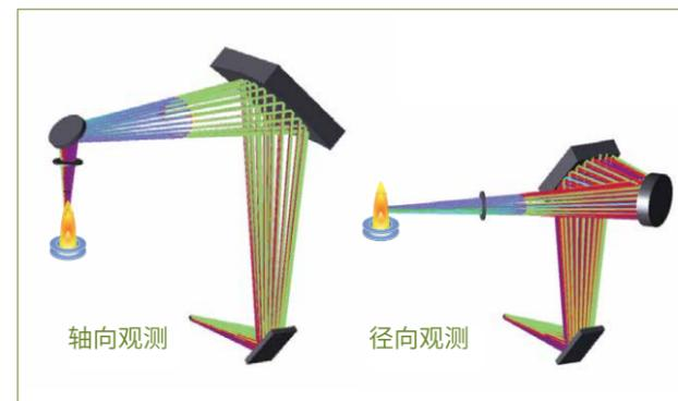
Avio 独特的垂直双向观测光学系统可确保宽的波长范围和合适的检测限。
