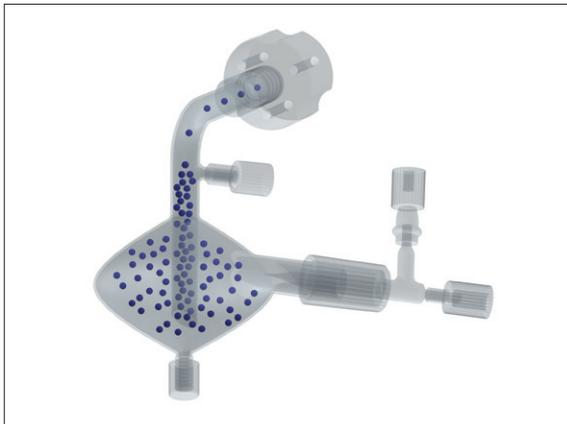
NexION 全基体进样系统 (AMS) 最小化样品分析时所需的稀释。
