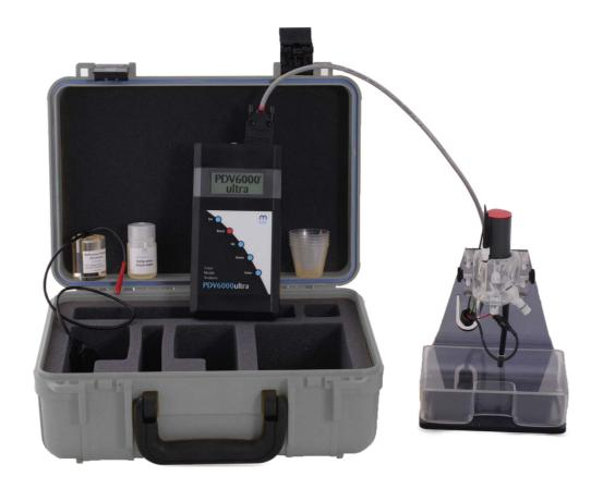
PDV 6000ultra 全面升级了现场单机检测功能,并增加了显示空白和标样结果可靠性的功能。仪器更大的屏幕可直接显示伏安图,USB 连接取代了原有的串口连接。PDV 6000ultra可由四节 I.5 伏 AA电池供电,也可由标准的 8-I2 伏直流电源供电。
