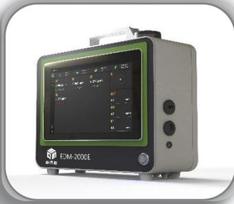
EDM-2000E 便携式恶臭分析仪适用于各种工业环境和特殊环境中的多种混合气体浓度检测,仪器采用PID、电化学、催化燃烧、红外等技术和多点校准等算法。设备响应速度快,测量精度高,稳定性和重复性好,各项参数用户可自定义设置,操作简单。
