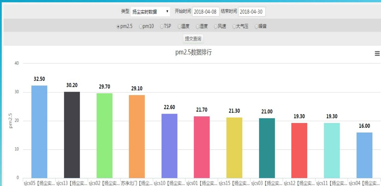
在点位排行界面中可以对该账号下所有空气微站的某一数据通道在选定时间段内进行平均数值的排行，可以更加直观看出来主要污染源的位置以及各区域空气质量情况，对长期高污染区域进行重点整治。
