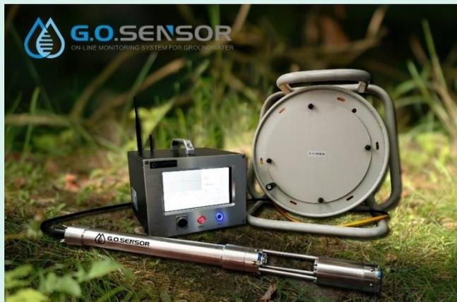
G.O.Sensor 采用视频管道显微摄影技术，通过显微镜头拍摄水中胶体粒子的移动轨迹，实时测定地下水流速。内置电子罗盘，精准定位流向。与传统的地下水流向流速测定方式相比，可以实现单井、快速、实时测量地下水流向流速。探头前端配置有井下摄录模块，可实时观测井下环境。
