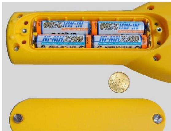
上图：使用硬币就可容易打开电池盒，仪器由四个可充电镍氢电池（AA 型）进行供电
