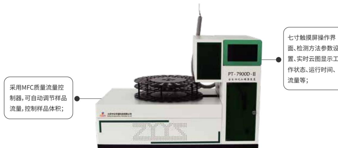
采用MFC质量流量控制器,可自动调节样品流量,控制样品体积;
