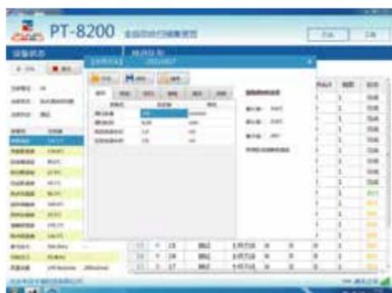
具有GC信号配置功能,可根据主机实际情况配置相应信号,无需重新接线适配。
