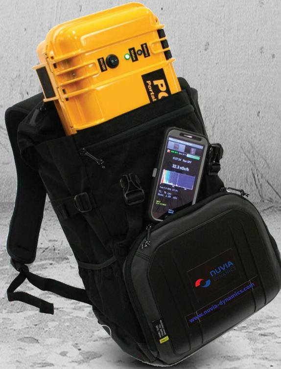
该仪器设计为便携式或背包式，可在各种复杂环境中进行放射性测量和监测。该系统由天然伽马峰自动校准，由一个与 GPS 集成的探测器单元和一个基于 Android 便携式设备（如智能手机、平板电脑或笔记本电脑）的数据记录单元组成。探测器可配备 NaI (TL) 晶体，体积从 0.347 升到 2 升不等。
