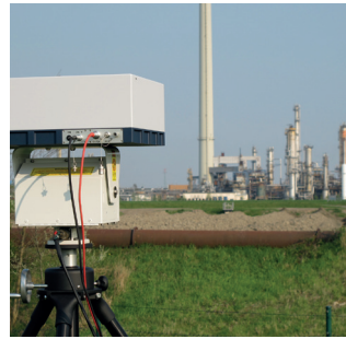
图3: HI 90 在工业监测中的应用。HI 90 实际测试的NH 3 光谱(一次扫描, 一个像素)和HITRAN 数据库中的参考光谱符合很好。
